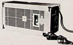
TA-144/2 AM-FM 2METER ZENDER-PRINT FM 1 W, AM 300 mW, VFO aansluiting. Microf.aansl. 200-5000 \Omega , Voeding 12 V. Geschikt voor 3 kristal kanalen 48...MHz Afm.55x100mm. 138
