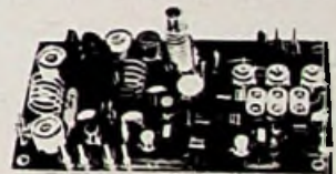
TA-144/2 AM-FM 2METER ZENDER-PRINT FM 1 W, AM 300 mW, VFO aansluiting. Microf.aansl. 200-5000 \Omega , Voeding 12 V. Geschikt voor 3 kristal kanalen 48...MHz Afm.55x100mm. 138
