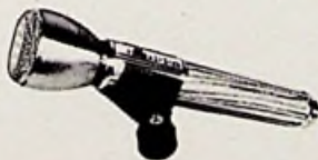
DM-120W STUDIO MICROFOON geschikt voor zowel 600 EN 50.000 \Omega , 100-12000 Hz. Gevoeligh.bij 600 \Omega -73 dB, bij 50k \Omega -54 dB. COMPL.MET 6M KABEL EN HOLDER:15.056 f59,00
